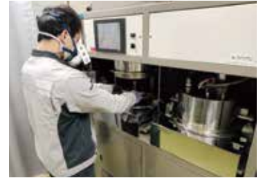
アスファルト合材の抽出試験
