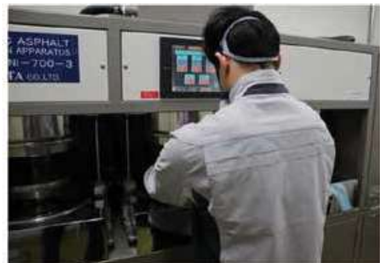
アスファルト試験（合材抽出試験）
