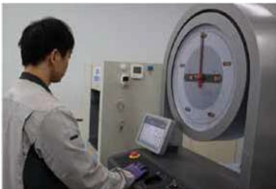
コンクリート試験（圧縮強度試験）
