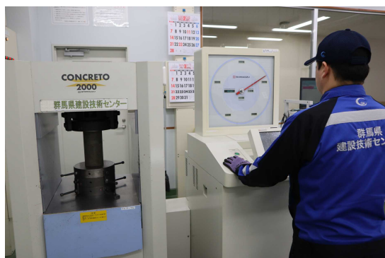
コンクリート試験（圧縮強度試験）
