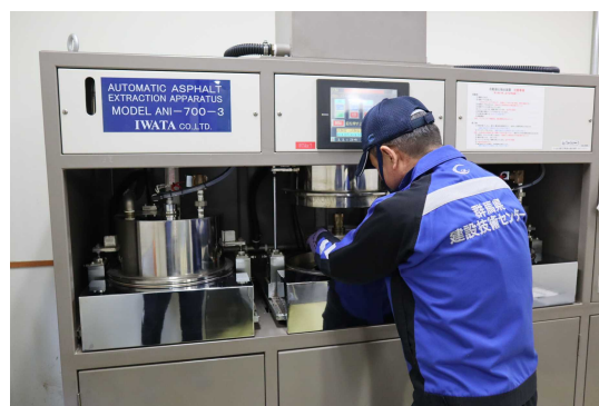
アスファルト試験（合材抽出試験）
