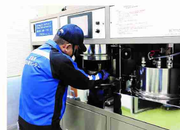
アスファルト合材の抽出試験
