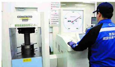
コンクリートの圧縮強度試験
