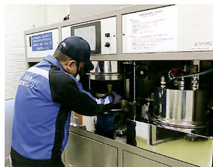
アスファルト合材の抽出試験
