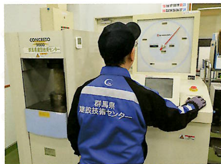
コンクリートの圧縮強度試験
