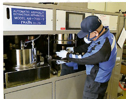
アスファルト合材の抽出試験
