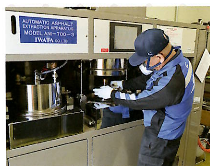
アスファルト合材の抽出試験
